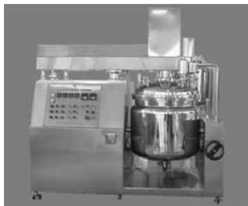
Рис 9.2. Вакуумний реактор з співвісними мішалками IMIXING (Росія)
