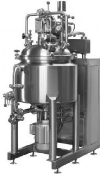
Рис. 9.7. Вакуумний гомогенізатор ZRJ-1000B (Україна).
