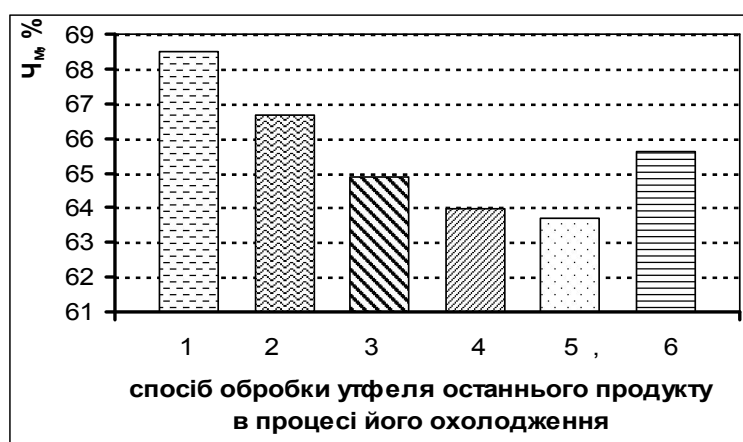
Рис.3. Залежність чистоти міжкристального розчину від способу обробки утфелю останньої кристалізації в кінці політермічної кристалізації: 1 – розкачка водою, 2 – розкачка мелясою, 3 – проміжний нагрів на 5 °С, 4 – проміжний нагрів на 7 °С, 5 - проміжний нагрів на 10 °С, 6 - проміжний нагрів на 12 °С
