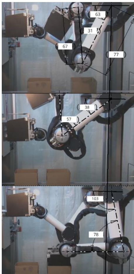
Рис. 5. Приклад декомпозиції відео роботи СРК TRIVEX® SL & Sli Douglas Machinery та визначення кутів повороту і розмірів ланок
