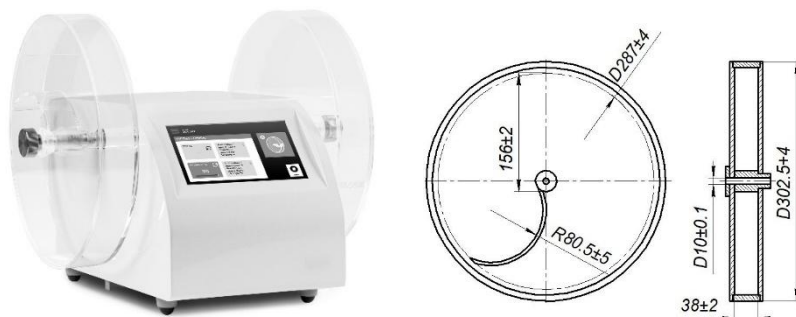
Рис. 4. Прилад для визначення стиранності таблеток ERWEKA TAR II
