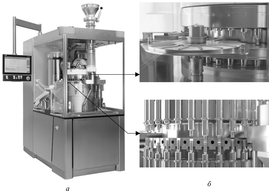
Рис. 1. Таблетпрес Korsch XL 400: а — загальний вигляд; б — вузли дозування і пресування
