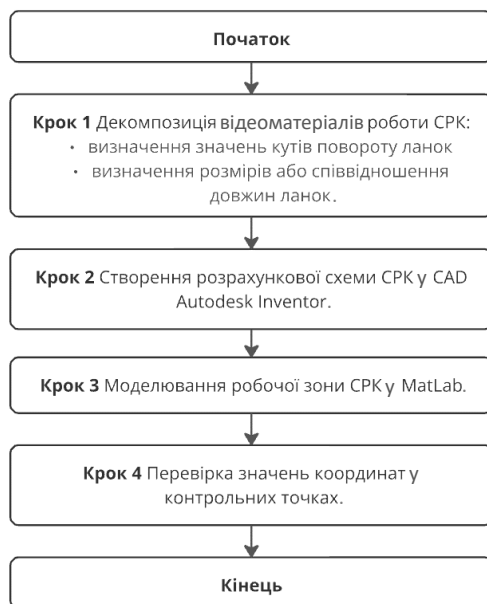
Рис. 4. Методика визначення робочої зони СРК
