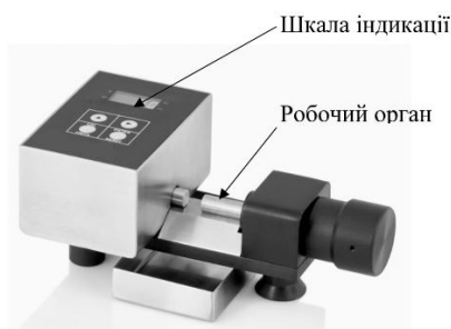
Рис. 3. Прилад для визначення міцності РТВ-М 300 N Pharma Test
