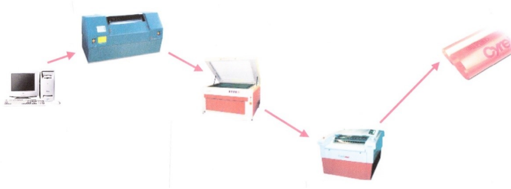
Рис. 4.2. Цифровий термальний спосіб виробництва ФДФ
