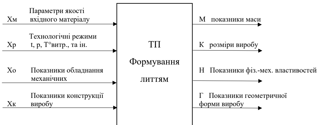
Рис. 3.1. Схема процесу формування литтям
