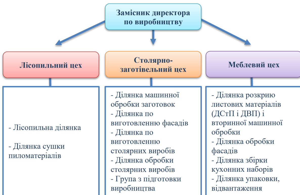
Рис. 2.2. Структурна схема технологічного процесу в ТОВ «Фабрика Класум»
