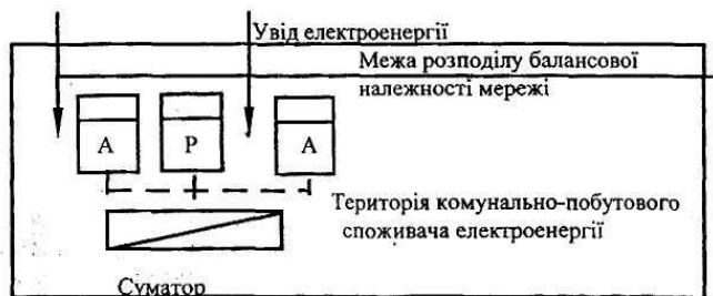
Рис. 7.3. Узагальнена структурна схема організації обліку електроспоживання на комунально-побутовому об'єкті.
