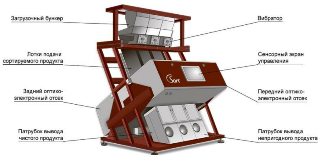
Рис. 2.4 Схематичне зображення фотосепаратора
