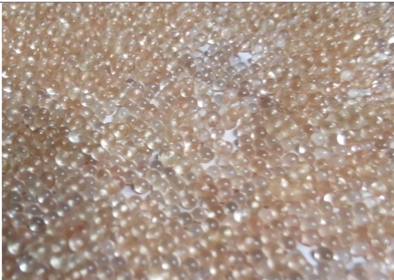
Рис. 2.6.5. Робочі тіла – бісер. Скло, діаметр 2 мм.
