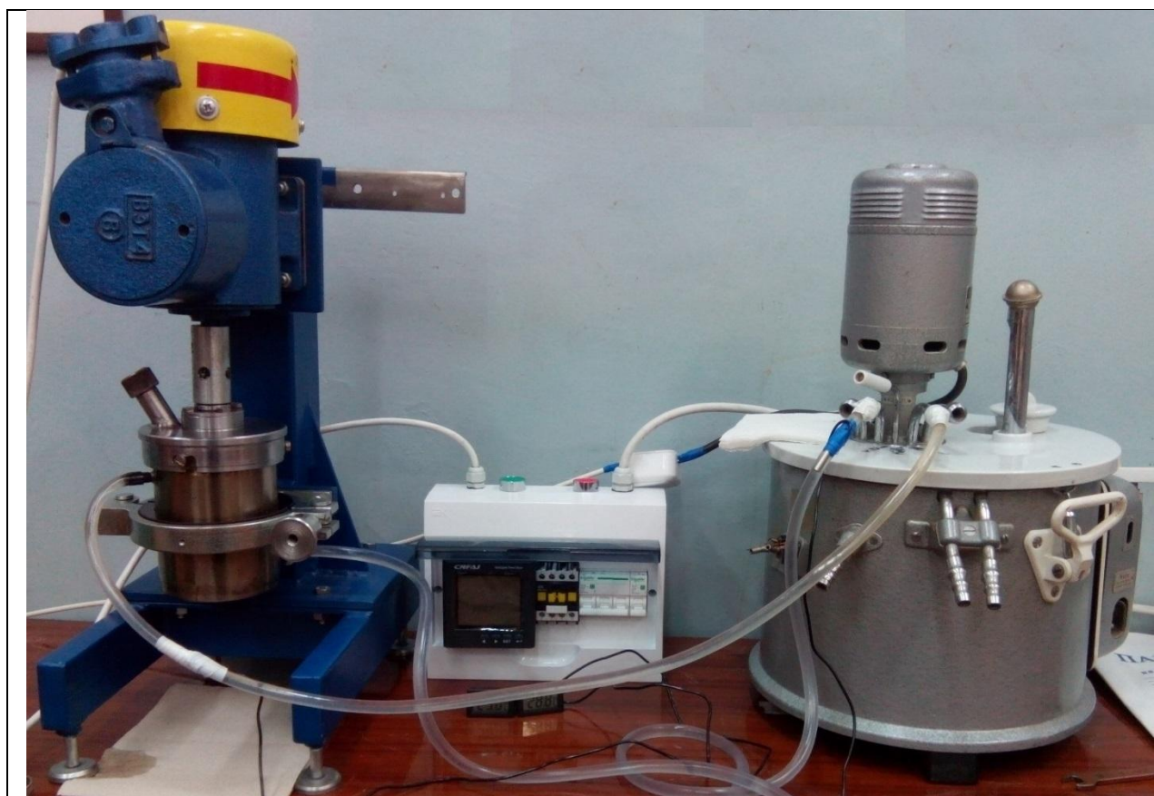
Рис. 2.6.2. Фотографія експериментального стенду – бісерного млина зі стаканом для надтонкого подрібнення компонентів лікарських і косметичних засобів та циркуляційний насос для водяного охолодження стакану з
