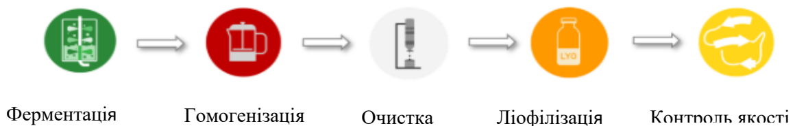
Рис.5.3. Загальна схема виробництва рекомбінантного людського основного фактору росту фібробластів в бактерії E. coli в штамі BL21 (DE3)plysS.
