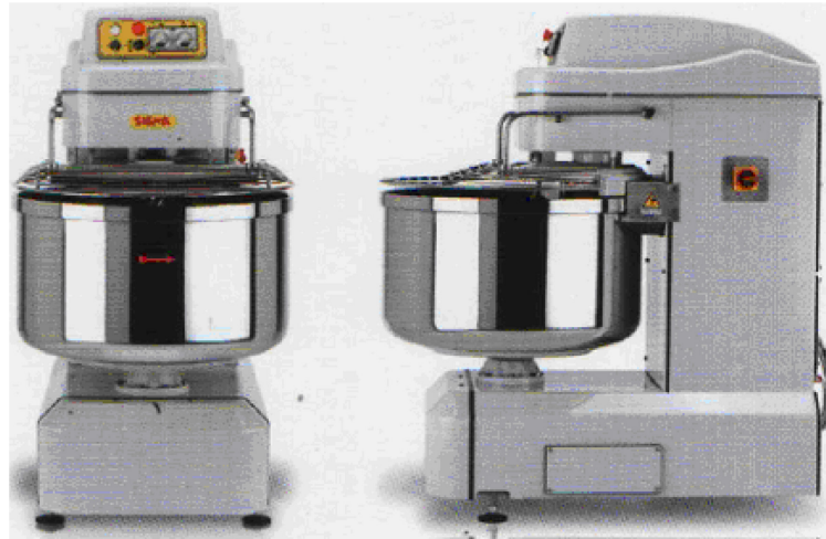
Рис. 6.1 Змішувач з нерухомою чашею й шнеком
