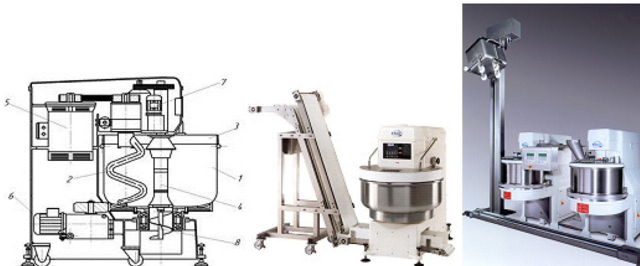
Рис. 2.1. Тістомісильна машина «Діосна» з нижнім вивантаженням тіста: 1 – діжа; 2 – спіральний робочий орган; 3 – кришка; 4 - нерухомий робочий орган; 5 – привід піднімання кришки; 6 – привід обертання діжі; 7 – привід перекривання вивантажувального патрубку і шнека; 8 – вивантажувальний шнек.
