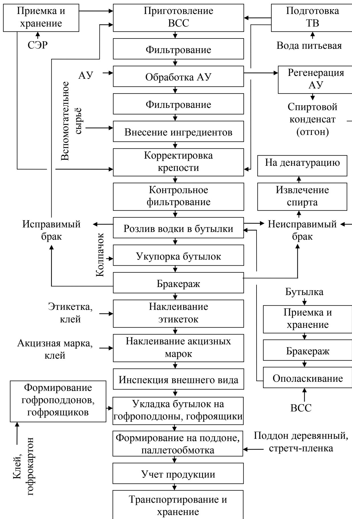
Рисунок 2.1 - Принципиальная схема производства водки
