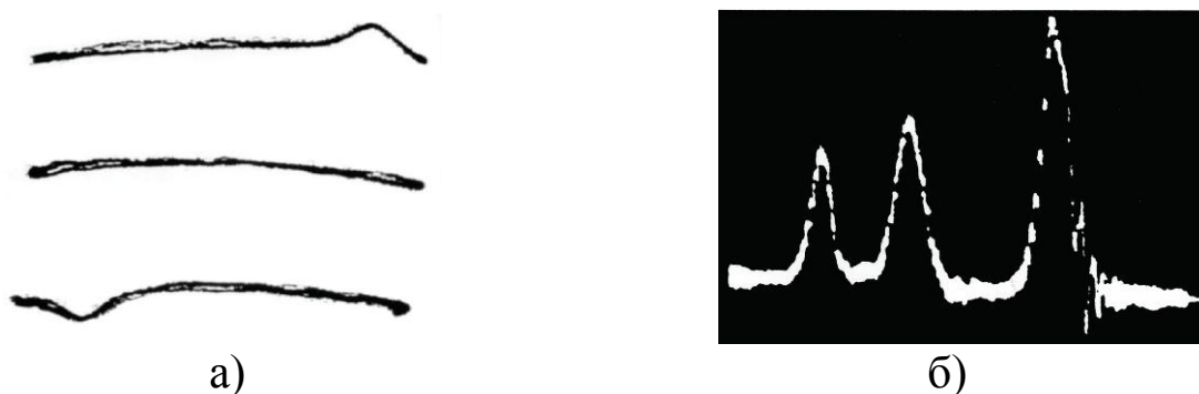
Рисунок 3.5 - ^1\text{H} ЯМР спектры: а – \text{H}_2\text{O} [554]; б – \text{C}_2\text{H}_5\text{OH} [535, 539, 540, 550, 585] – (слева направо) протоны гидроксильной (ОН), метиленовой ( \text{CH}_2 ) и метильной ( \text{CH}_3 ) групп
