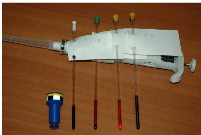
Рисунок 3.13 - Ампулы с дейтерорастворителем и экспериментальными растворами
