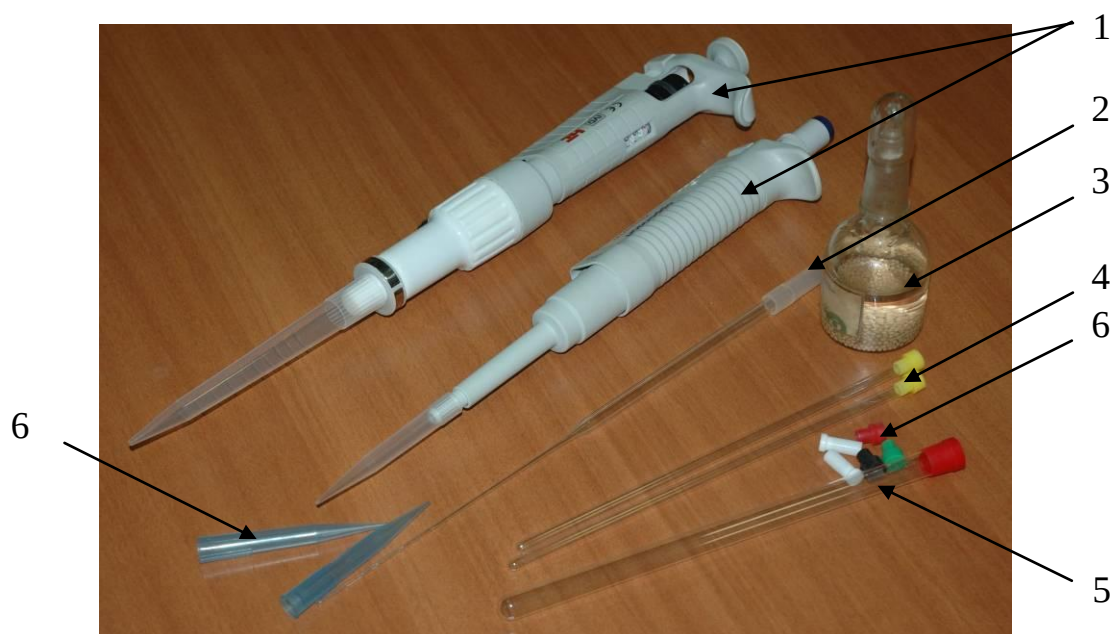
Рисунок 3.12 - Материалы для пробоподготовки при использовании жидкостного датчика: 1 – дозаторы; 2 – мерная пипетка; 3 – колба с дейтерорастворителем; 4 – ампулы 5 мм; 5 – ампула 10 мм; 6 – колпачки
