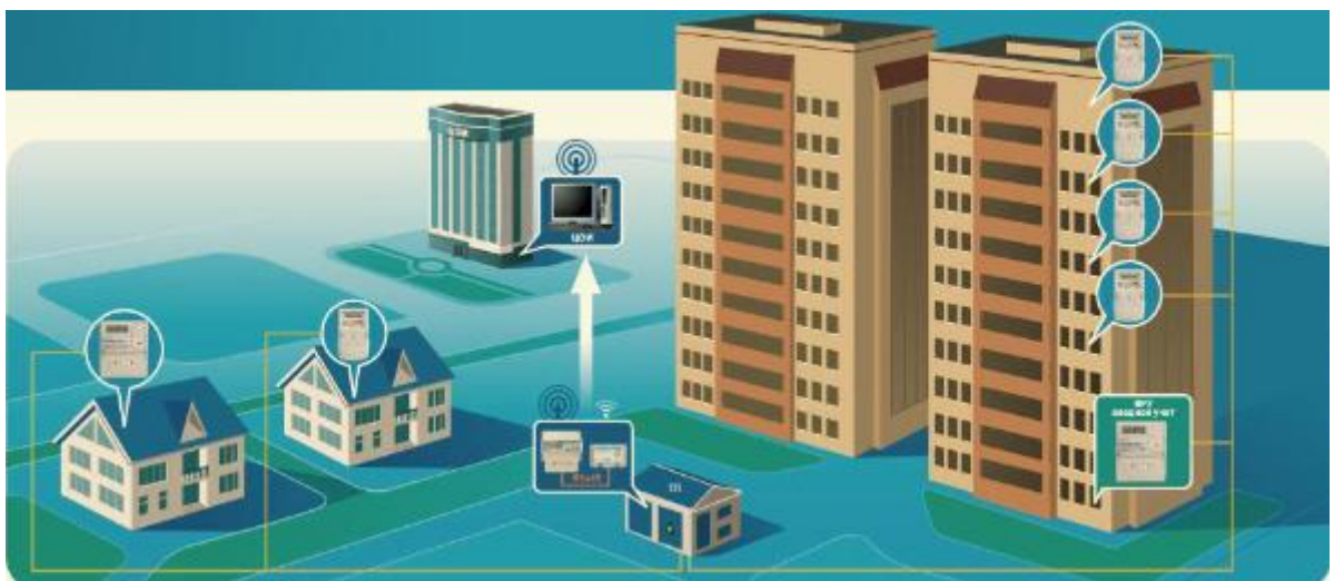
Рис. 7.1.2 Структурна схема передачі даних по PLC-технології
