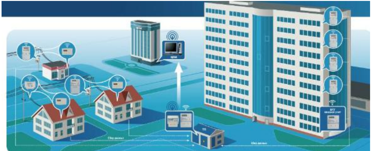
Рис. 7.1.3 Структурна схема передачі даних за допомогою RADIO
