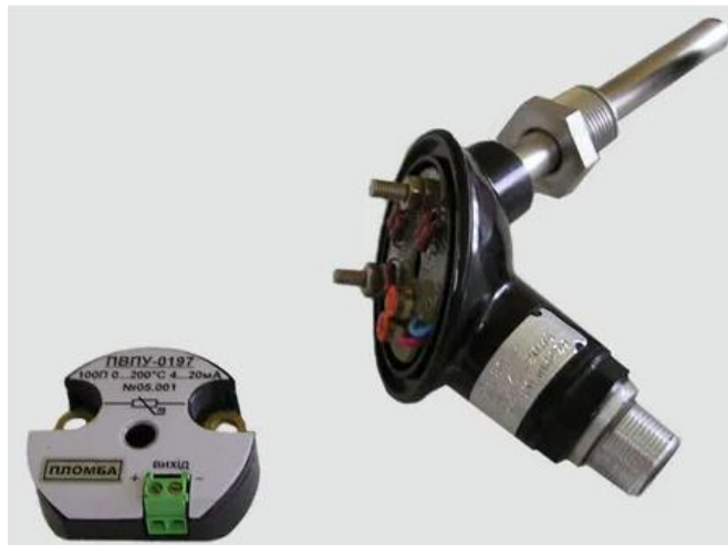
Рисунок 2.1 – Термоперетворювач ТХАУ-0289 з вбудованим перетворювачем ПВУ-0197
