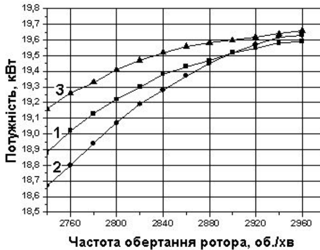
Рис. 10. Залежність інтегрованої потужності емульсатора від частоти обертання ротора – результати, одержані шляхом вимірювання та розрахунку.
