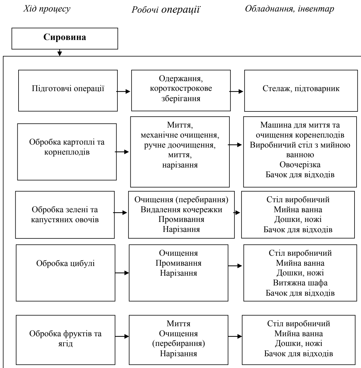
Рисунок 3.5 – Структурно-технологічна схема виробничого процесу овочевого цеху
