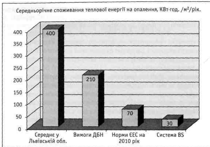
Рис. 2. Середньорічне споживання теплової енергії на опалення
