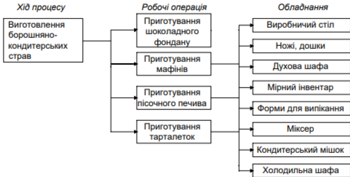
Рис 3.6. Структурно-технологічна схема виробничого процесу кондитерського цеху
