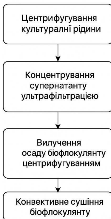
Рис.5.1. Блок-схема виділення та очищення біофлокулянту
