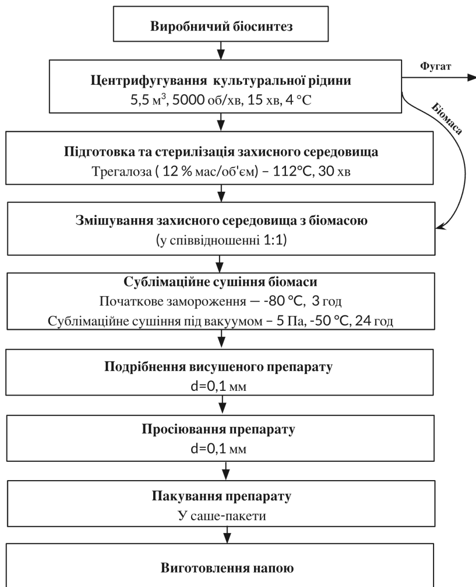
Рис. 4.2 Схема післяферментаційних стадій отримання готової субстанції
