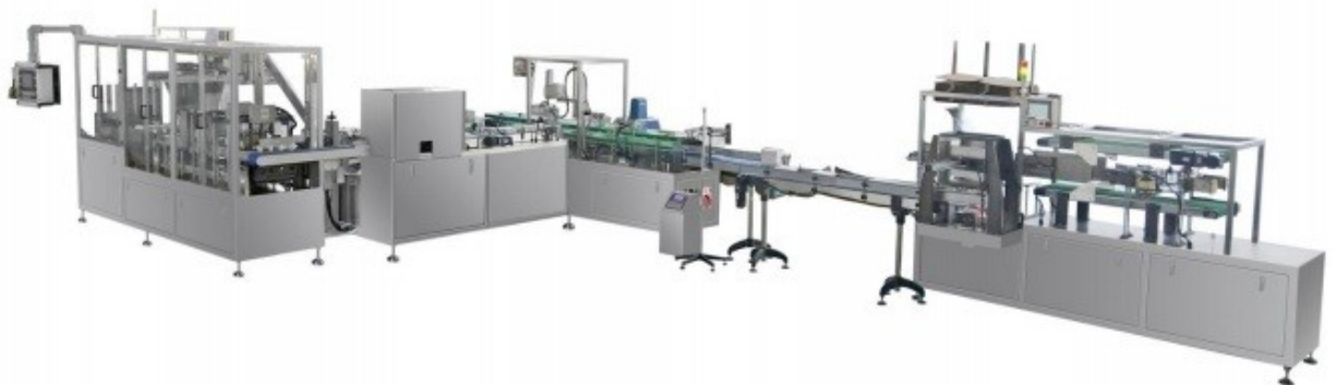
Рис 3.7. Двохпотокова машина по фасуванню і спайці капсул НЕСПРЕССО
