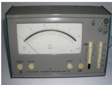
Рис. 2.3. Іонометр універсальний ЕВ-74 для визначення кислотності
