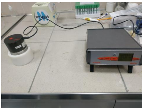
Рис. 2.6. Прилад «HygroLab 2» для визначення активності води
