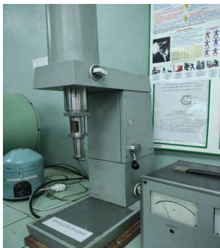
Рис. 2.4. Ротаційний віскозиметр «Реотест-2»
