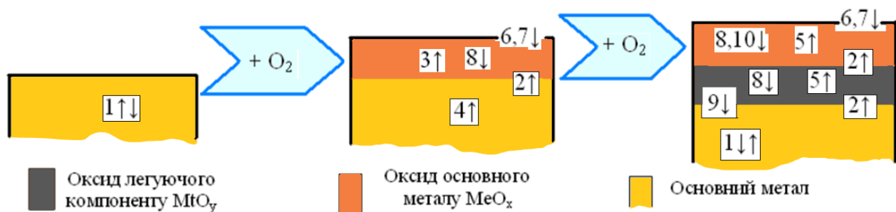
Рис.1. Схема утворення зони внутрішнього окиснення за О. Кубашевським, і Б. Гопкінсом: 1 – дифузія атомів всередині сплаву; 2 – іонізація атомів Me з утворенням іонів та електронів; 3 – дифузії іонів Me та електронів у прошарку \text{MeO}_x ; 4 – іонізація атомів ліганду Mt з утворенням іонів та електронів; 5 – дифузії іонів Mt та електронів у прошарку \text{MeO}_x і \text{MtO}_y ; 6 – адсорбція кисню на межі метал-рідина; 7 – іонізація адсорбованого кисню; 8 – дифузії іонів кисню в шарі оксиду; 9 – реакція взаємодії іонів Me з \text{O}^{2-} ; 10 – реакція взаємодії іонів Mt з \text{O}^{2-} . [6]
