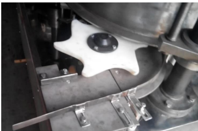
Рис. 3.1. Приклад виконання проміжної зірочки з полімерного матеріалу.
