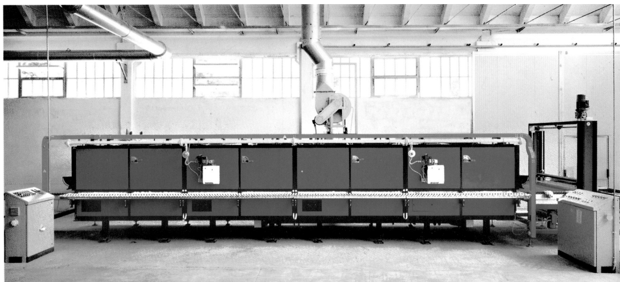
Рис. 1.4. Сушарка ЕК/О-DRYER фірми "КЕМАС" для сушіння глазурованої плитки з нанесеними на глазур муфельними фарбами.
