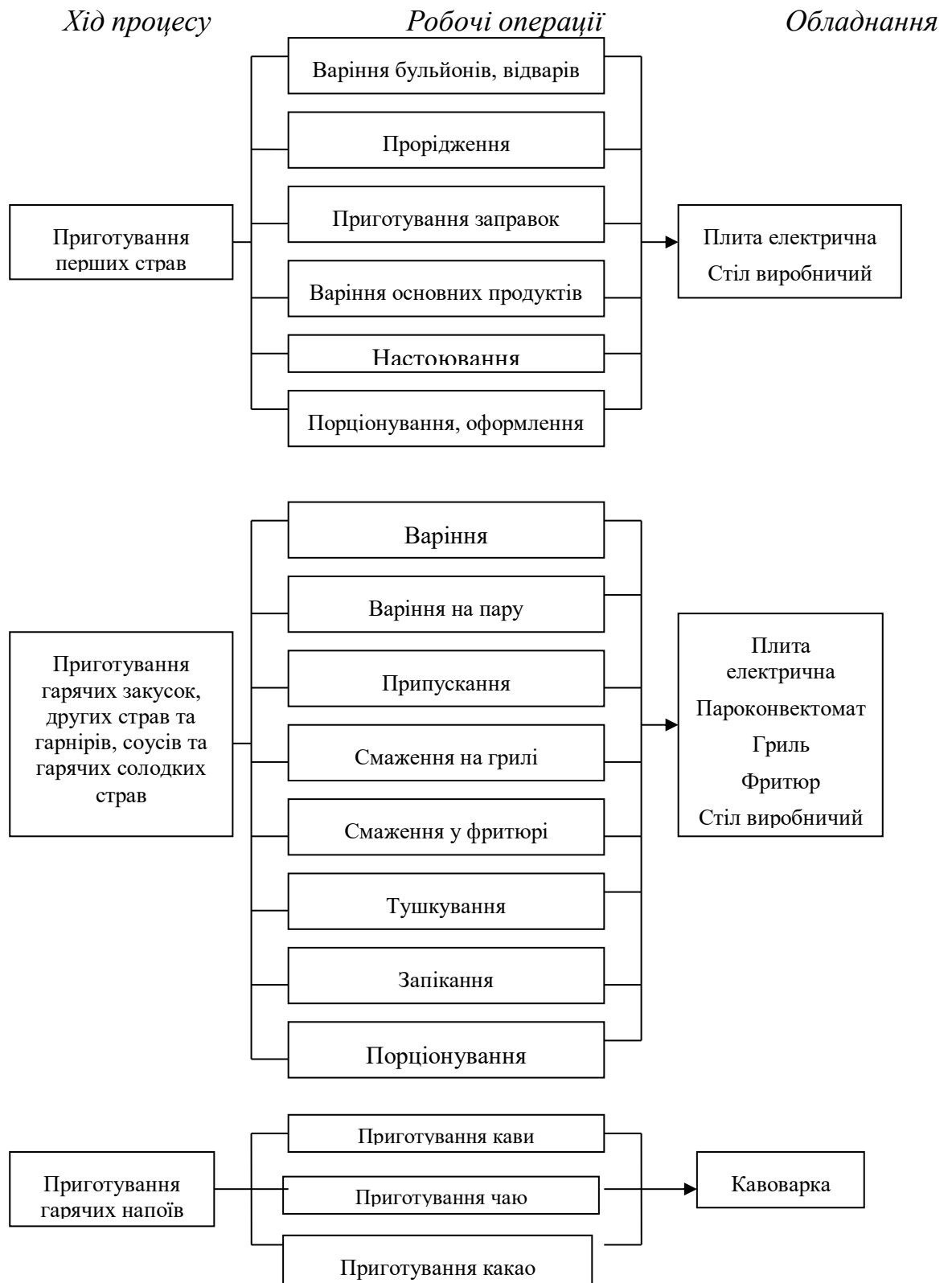
Рис. 2.6 – Структурно-технологічна схема виробничого процесу гарячого цеху Холодний цех –це цех, призначений для приготування, порціювання і оформлення холодних страв і закусок, солодких страв і холодних супів та напоїв. У відповідності до виробничої програми холодного цеху
