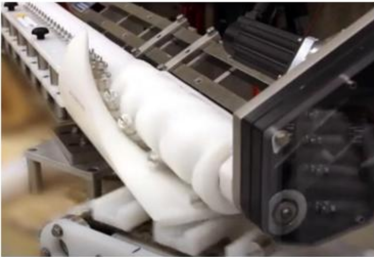
Рис.2.9. Транспортна система з використанням шнека та пасивної напрямної площини для переорієнтування упаковки в просторі
