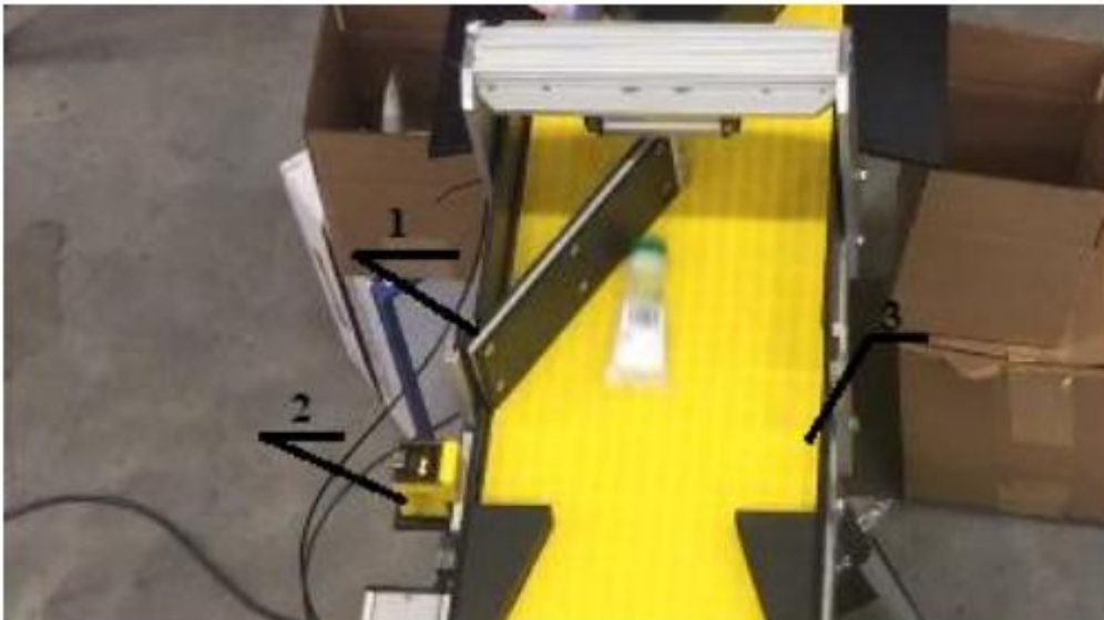
Рис.1.2 Система транспортування з використанням активних напрямних: 1- рухомий напрямний елемент, 2- датчики положення та швидкості, 3- стрічка конвеєра
