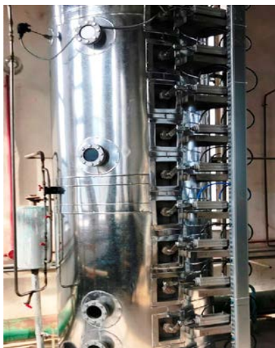
Рис. 1. Експериментальна ректифікаційна колона циклічної дії
