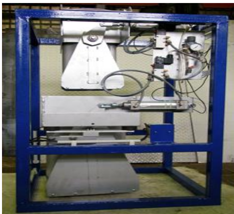
Рис. 11 Дозатор НВП “Техноваги” призначений для дозування сипких продуктів по масі.
