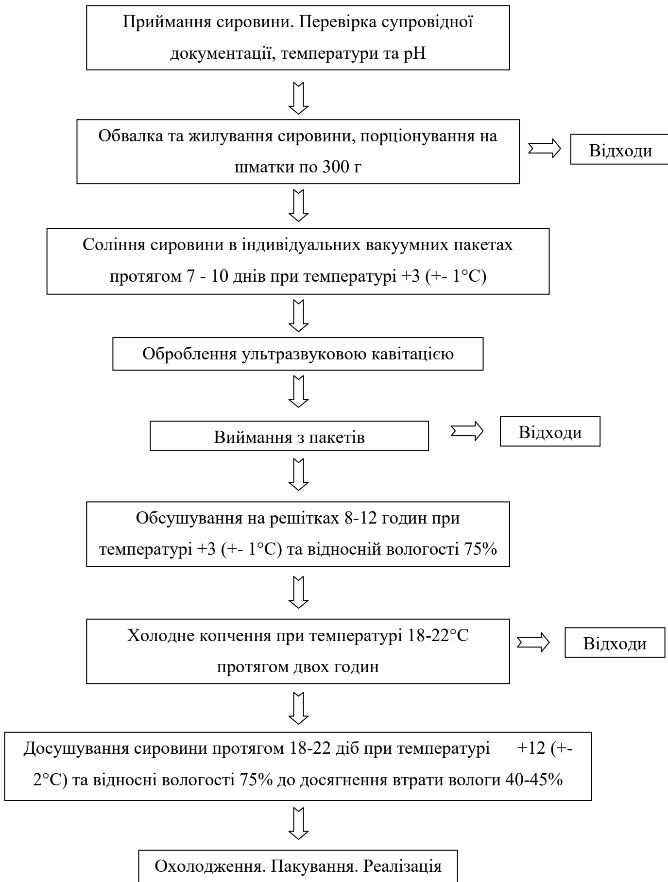
Рис. 3.7 Технологічна схема виробництва сирокопченої яловичини використанням ультразвукової кавітації.
