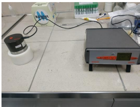
Рис. 2.1 Прилад «HygroLab 2» для визначення активності води
