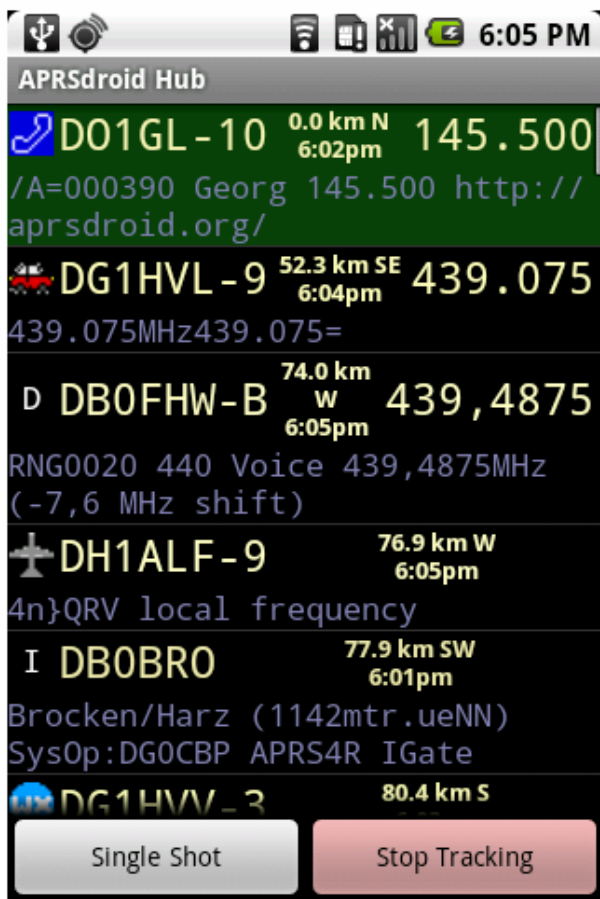
Рис. 5. Скріншот APRSDroid вузлів APRS
