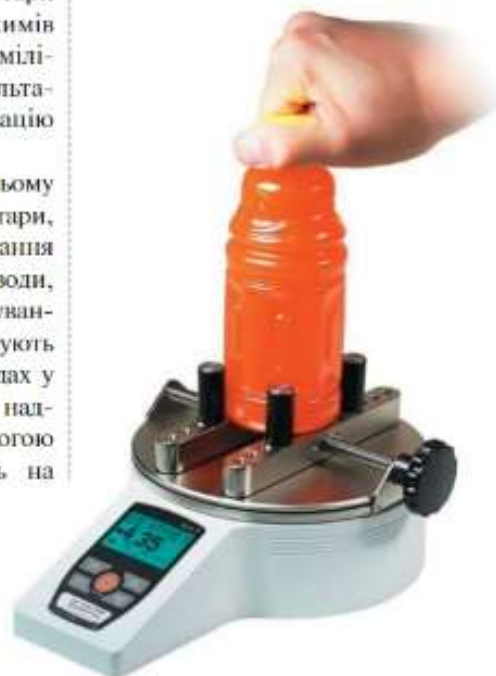
Рис. 2. Тестер TT01 для перевірки міцності та моменту закручування різьбових кришок полімерних пляшок
