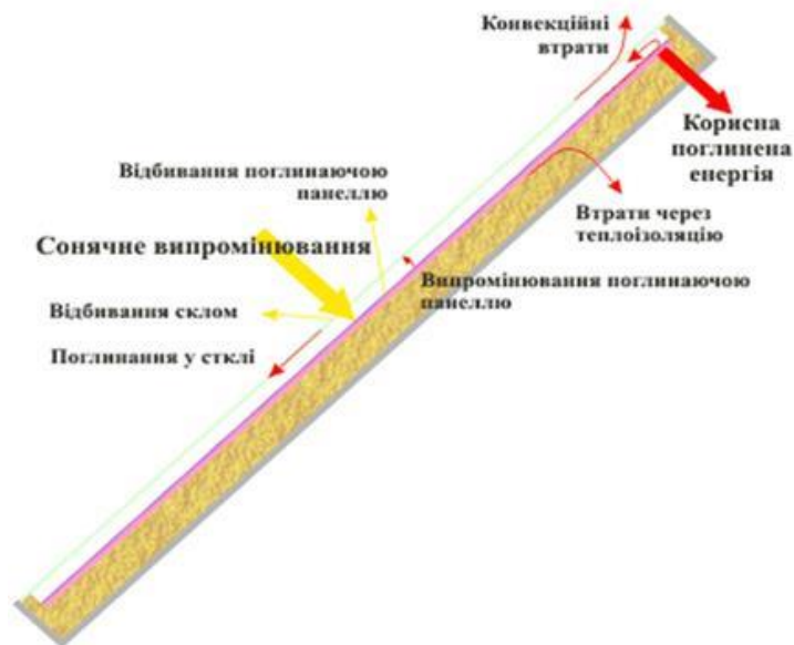
Рис. 8.3. Втрати теплової енергії у плоскому сонячному колекторі
