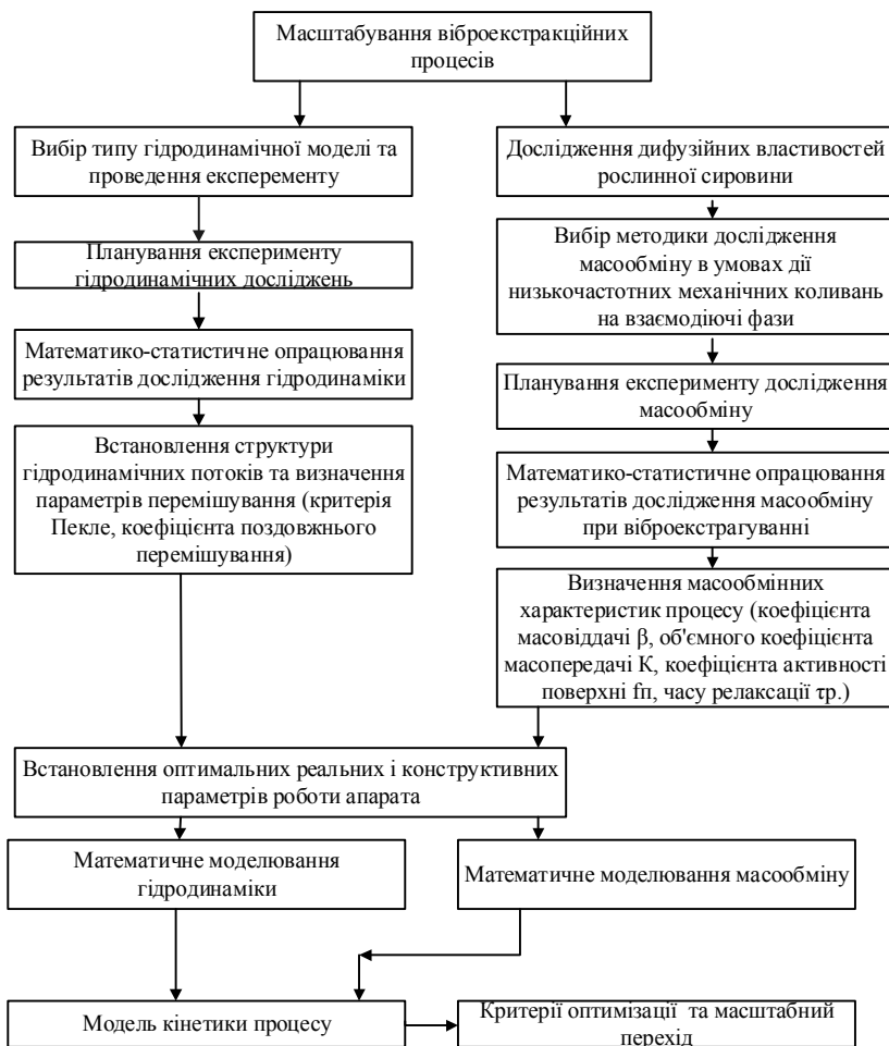
Рис.18. Схема алгоритму масштабного переходу при віброекстрагуванні турбулентних пульсуючих струменів, що створюються секціонуючими апарат поперечними віброуючими перегородками, або іншими пристроями спеціальної конструкції.
