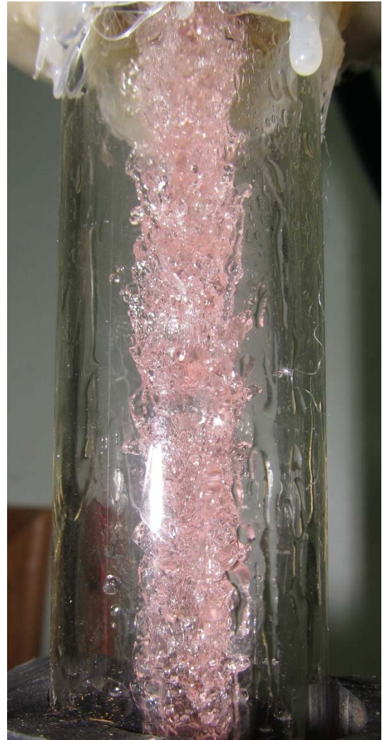
Рис. 3.2 Характерний режим течії рідини в ежекторі d_c=8 мм, D_{кз}=27 мм
