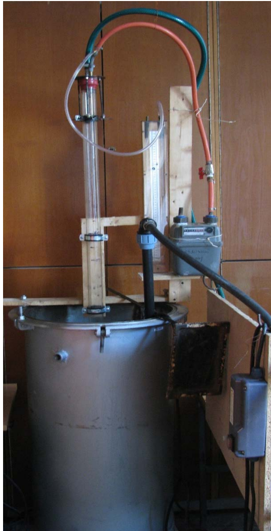
Рис.3.1 Дослідна установка з вертикальним положенням камери змішування
