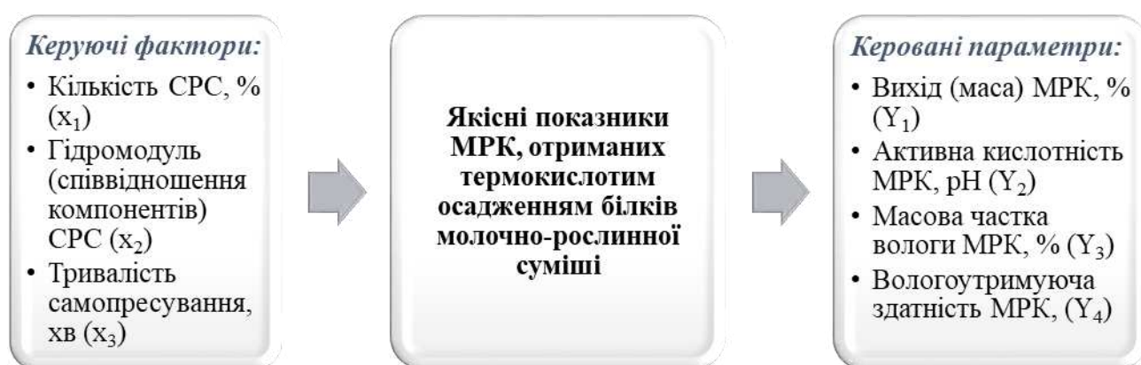
Рисунок 4.1 – Параметрична схема процесу отримання МРК термокислотним осадженням білків молочно-рослинної суміші
