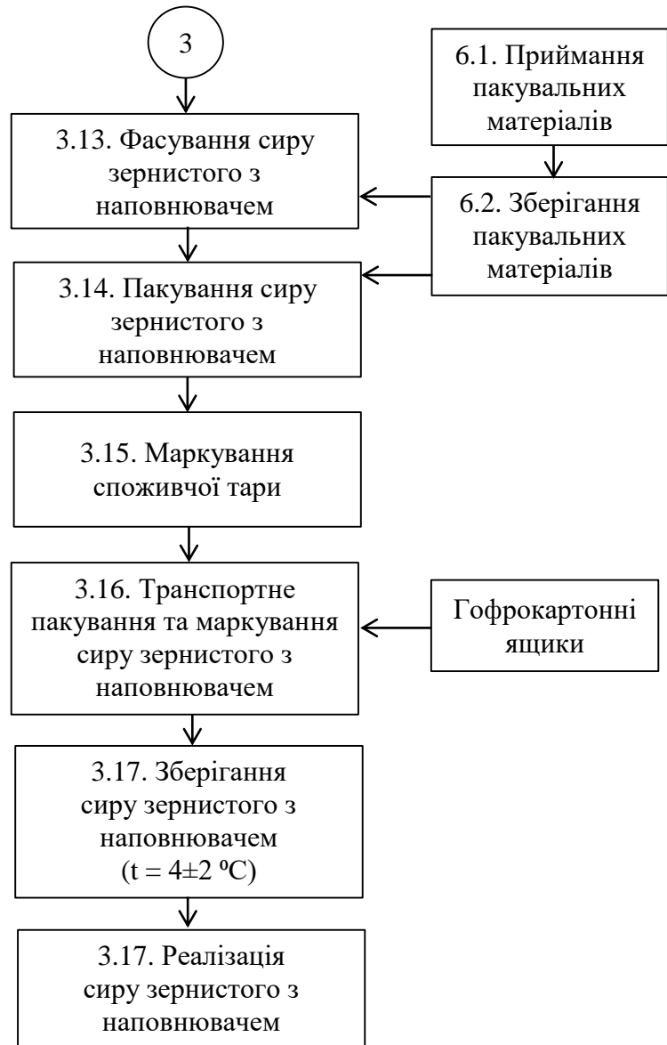
Рис. 2.1. Діаграма послідовності процесів виробництва сиру кисломолочного зернистого "Cottage cheese" з наповнювачем фруктовим "Полуниця"
