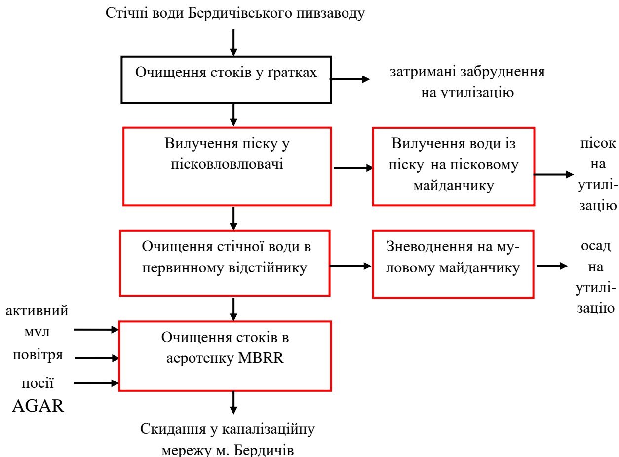
Рисунок 4.6 – Принципова технологічна схема очищення стічних вод Бердичівського пивзаводу (нове обладнання позначене червоним кольором)
