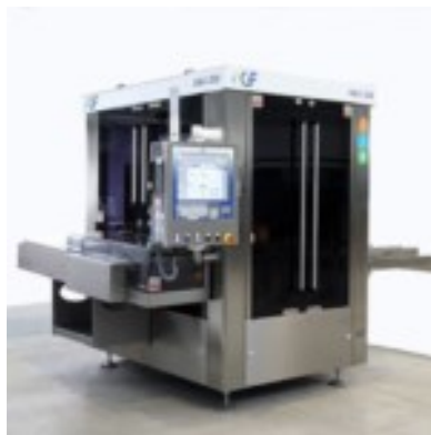
Рис. 5.13 Автоматична інспекційна машина для ампул, картриджів та флаконів малого діаметру, модель A&V 600 (Росія)
