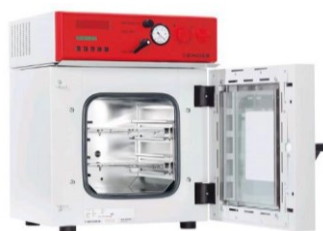
Рис. 5.8 Зовнішній та внутрішній вигляди вакуум-сушильної шафи моделі BINDER VD 23
