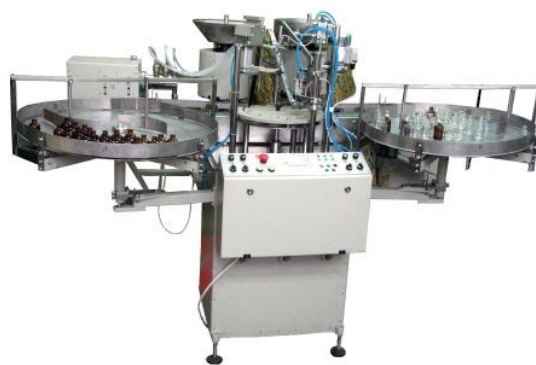
Рис. 5.12 Автоматична лінія розливу та закупорювання рідких препаратів у флакони, модель ТБ-056 (Україна)
