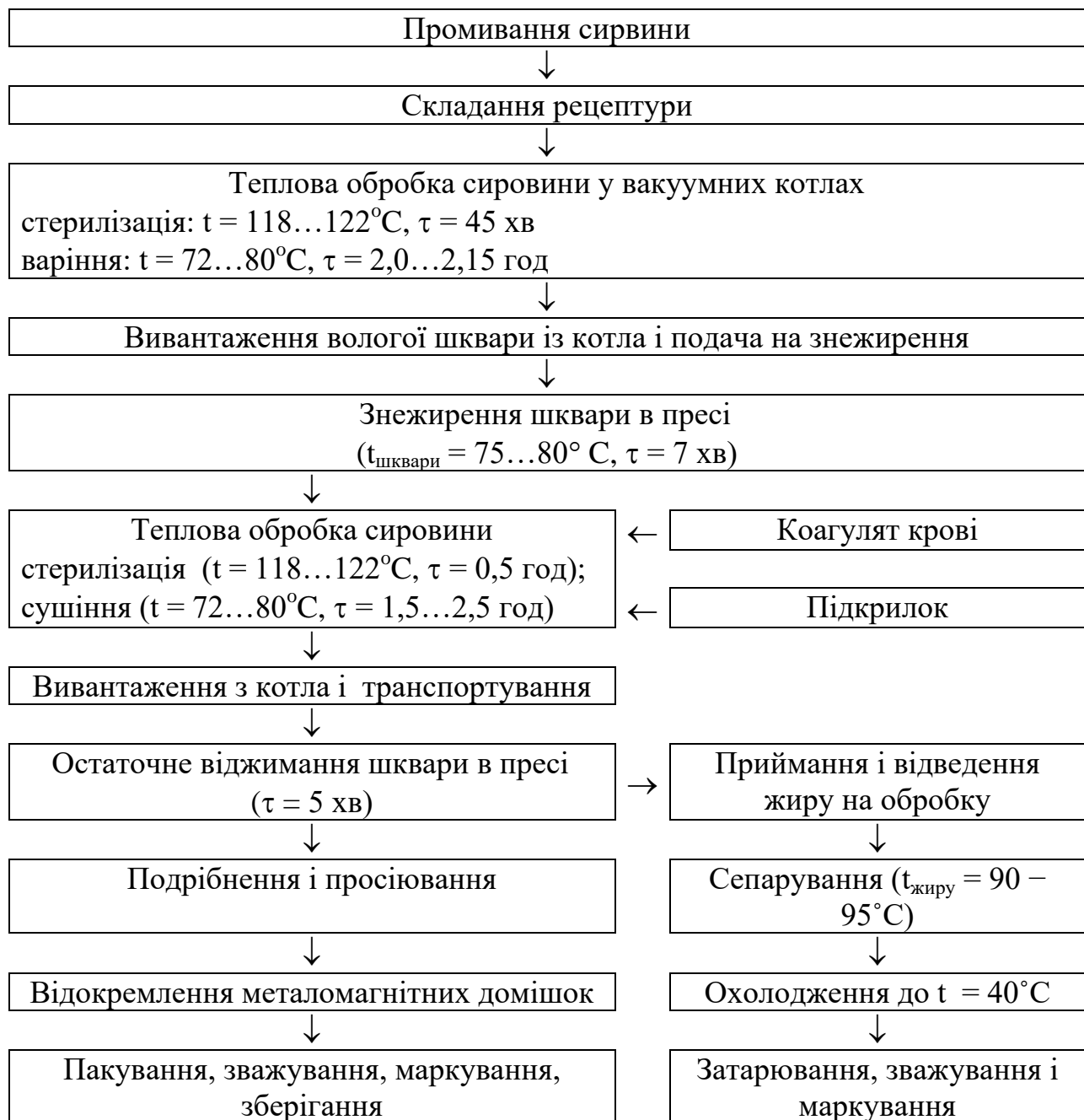
Рис.2.8. Технологічна схема виробництва м'ясо-кісткового борошна і технічного жиру
