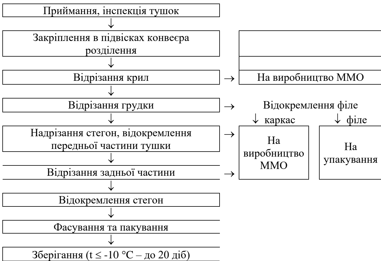
Рис.2.3. Технологічна схема натуральних напівфабрикатів водоплавної птиці
