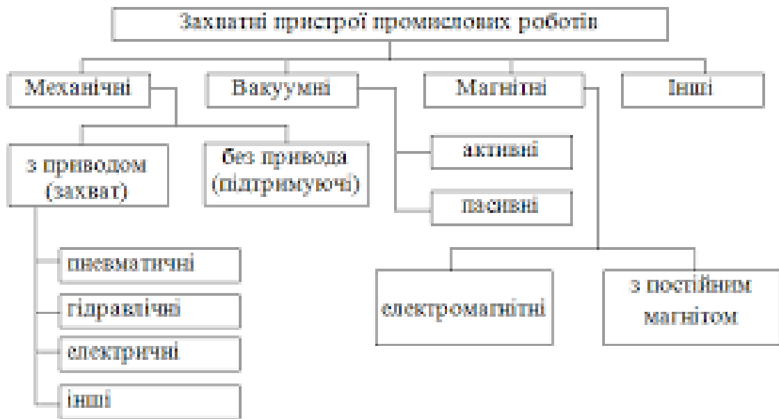
Рисунок 1.13. Систематизація фрикційних захватних пристроїв за конструктивними характеристиками
