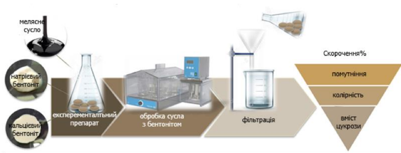
Рис. 4. Схема обробки сусла суспензією бентоніту[40].
