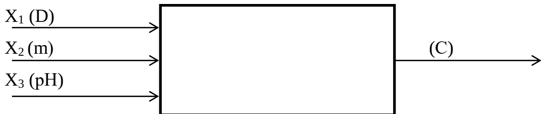
Рис. 7 Модель чорного ящика процесу зброджування м'ясного суслу, попередньо обробленого бентонітом
