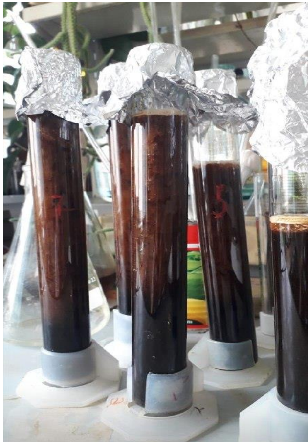
Рис. 6. Процес освітлення сусла з використанням суспензії бентоніту.
