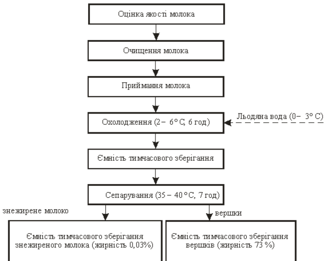
Схема технологічного процесу в цеху приймання молока
