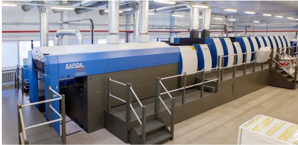
Рис. 4.3.1. – друкарської машини KBA Rapida 74 4
