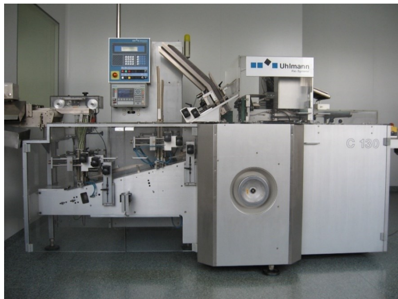
Рис. 2.1.1.3 – Загальний вигляд машини для укладання блістерів в пачки
