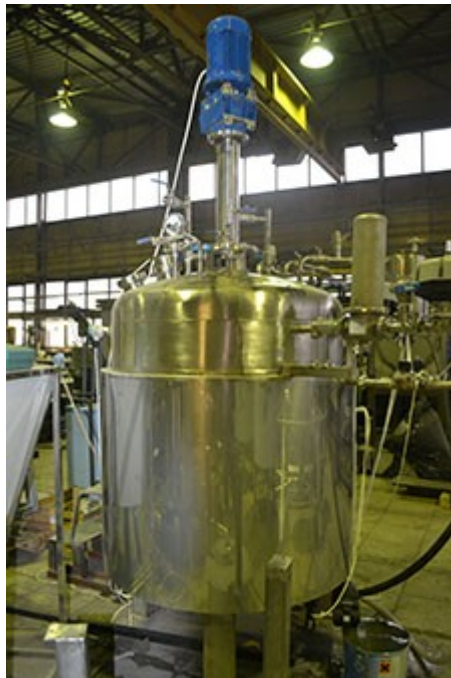
Рис. 5.1 Ферментер з механічним перемішуванням барботажного типу
