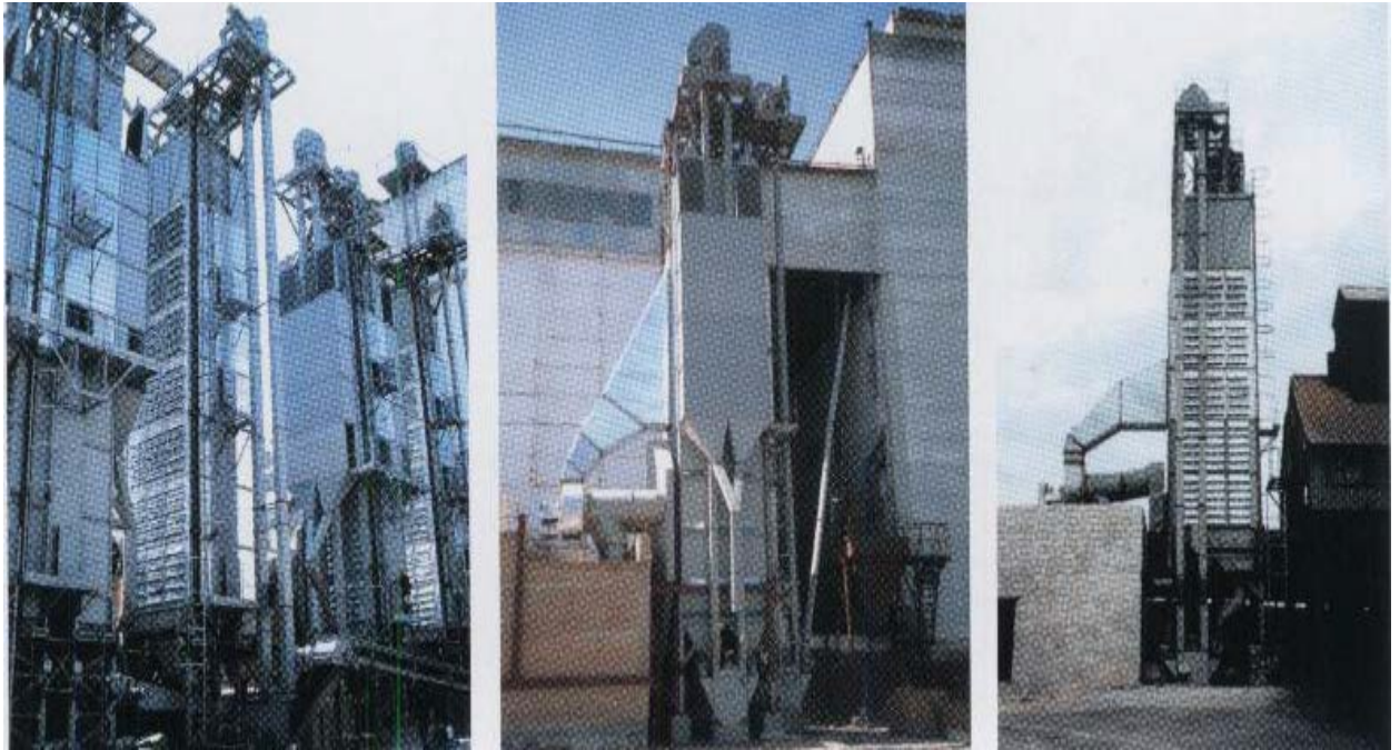
Рис. 1.8. Рециркуляційні зерносушарки Карлівського МЗ (Україна) 2хА1 – ДСП – 50 (а), А1 – ДСП – 50 (б) та ДСП – 25 (с)
