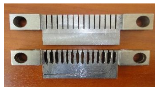
Рис. 2. Нова (матеріал – сталь 40X13 (DIN X38Cr13) після 300 годин експлуатації та зношена напрямна рамки шпигорізки
