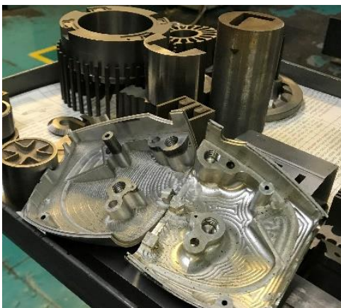
Рис. 1. Вироби, одержані електроерозійною обробкою
