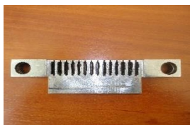
Рис. 1. Напрямна рамки шпигорізки після 1000 годин експлуатації
