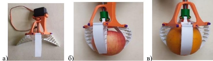
Рис.1. Трьохпальцевий захоплювальний пристрій типу MultiChoice:
