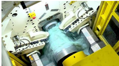
Рис. 1. Ротаційне протягування апаратом Repkon RFFM 330-138-300 CNC
