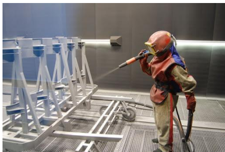
Рис. 1. Піскоструменеве очищення металевих поверхонь у спеціальній камері
