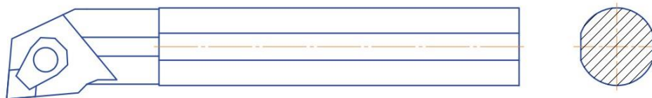
Рис. 1. Розточний токарний різець марки S32X-MCLNL 12-Bh 12
