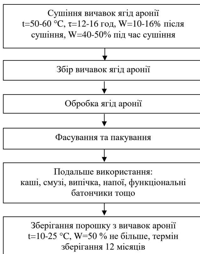
Рис. 4.2. Принципова технологічна схема виробництва порошку з вичавок ягід аронії
