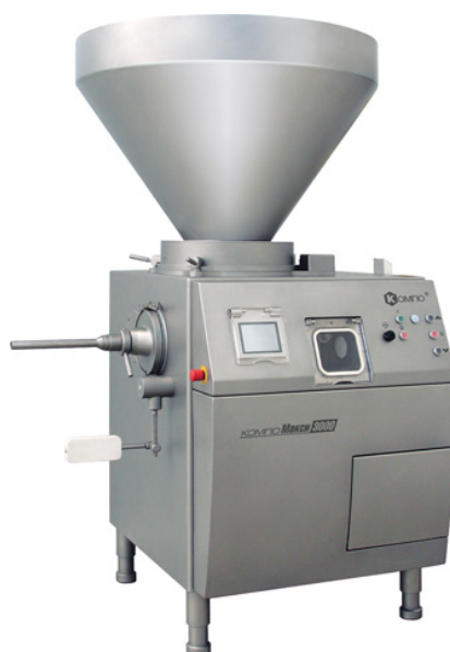
Рис. 1.2. Шприц вакуумний КОМПО–МАКСИ
