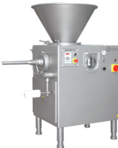
Рис. 1.1. Шприц вакуумний КОМПО–МИНИ 1500
