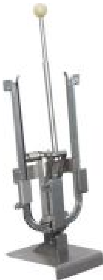
Рис. 1.5. Кліпсатор настільний ручний двохскріпковий КОМПО КН-8р
