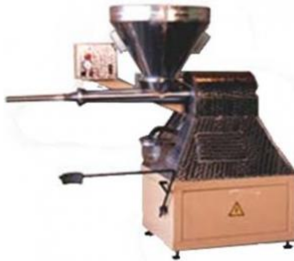
Рис. 1.3. Шприц вакуумний двошнековий ШВ–1
