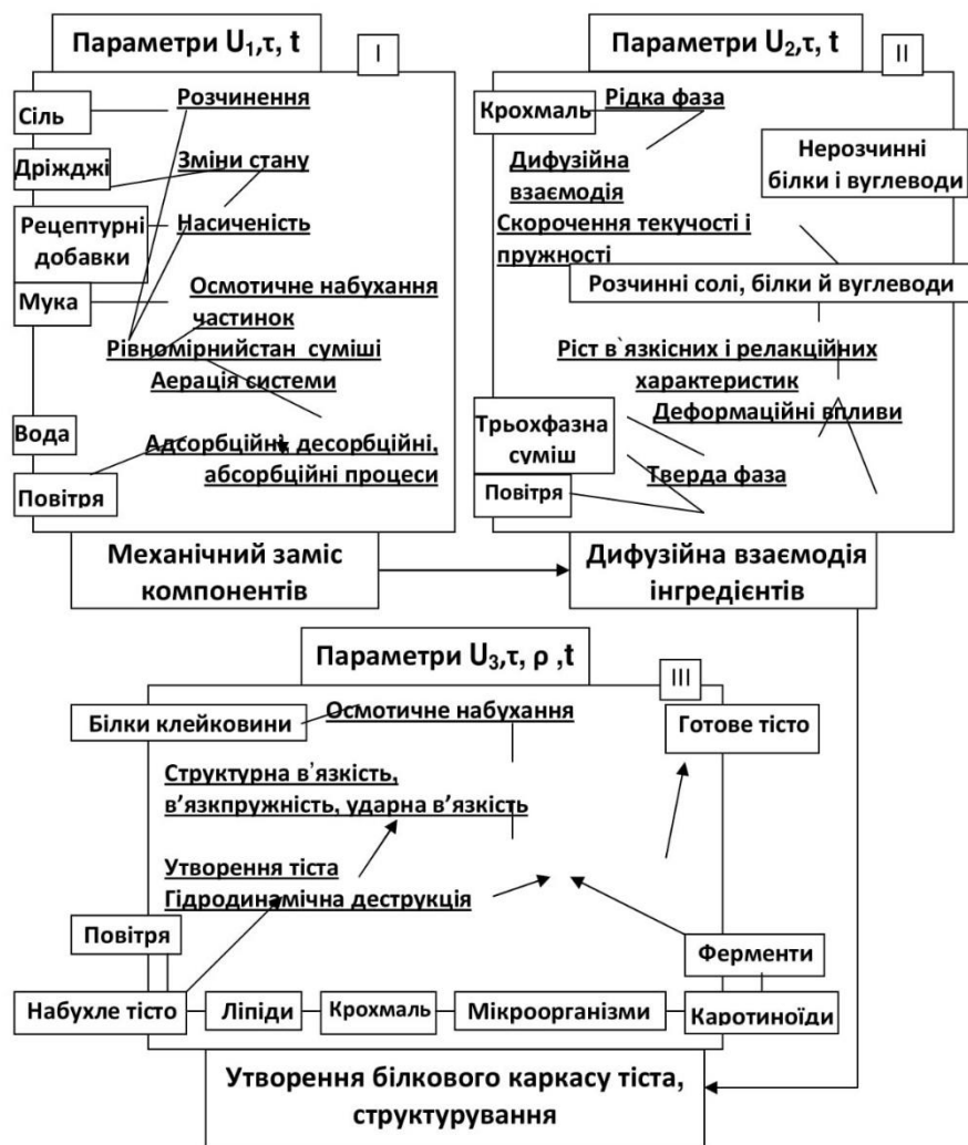
Рис. 1.1. – Структурна схема трістадійної моделі замішування тістової маси: I - механічне змішування рецептурних компонентів тіста; II - дифузна
